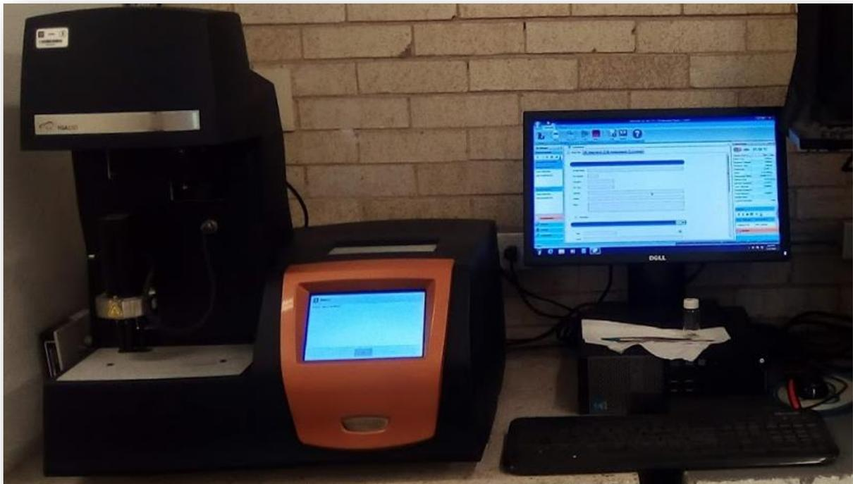
**Figura 11:Equipo de Análisis termogravimétrico marca TAInstruments modelo TGA550.**
