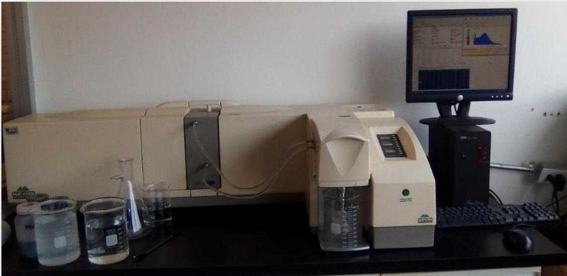
**Figura 9** Equipo de medición de tamaño de partícula Malvern Mastersizer 2000
