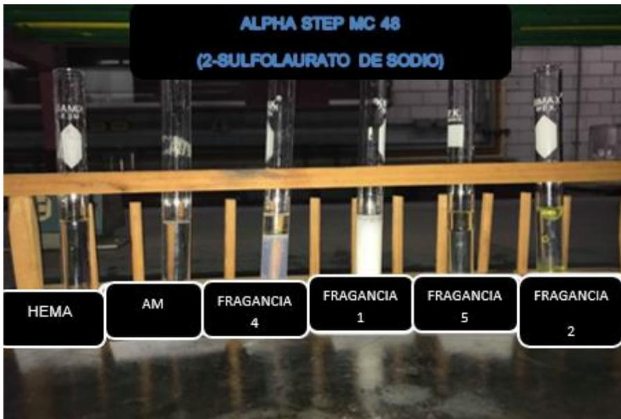
Figura 7: Pruebas con tensoactivo ALPHA STEP MC 48 ®
