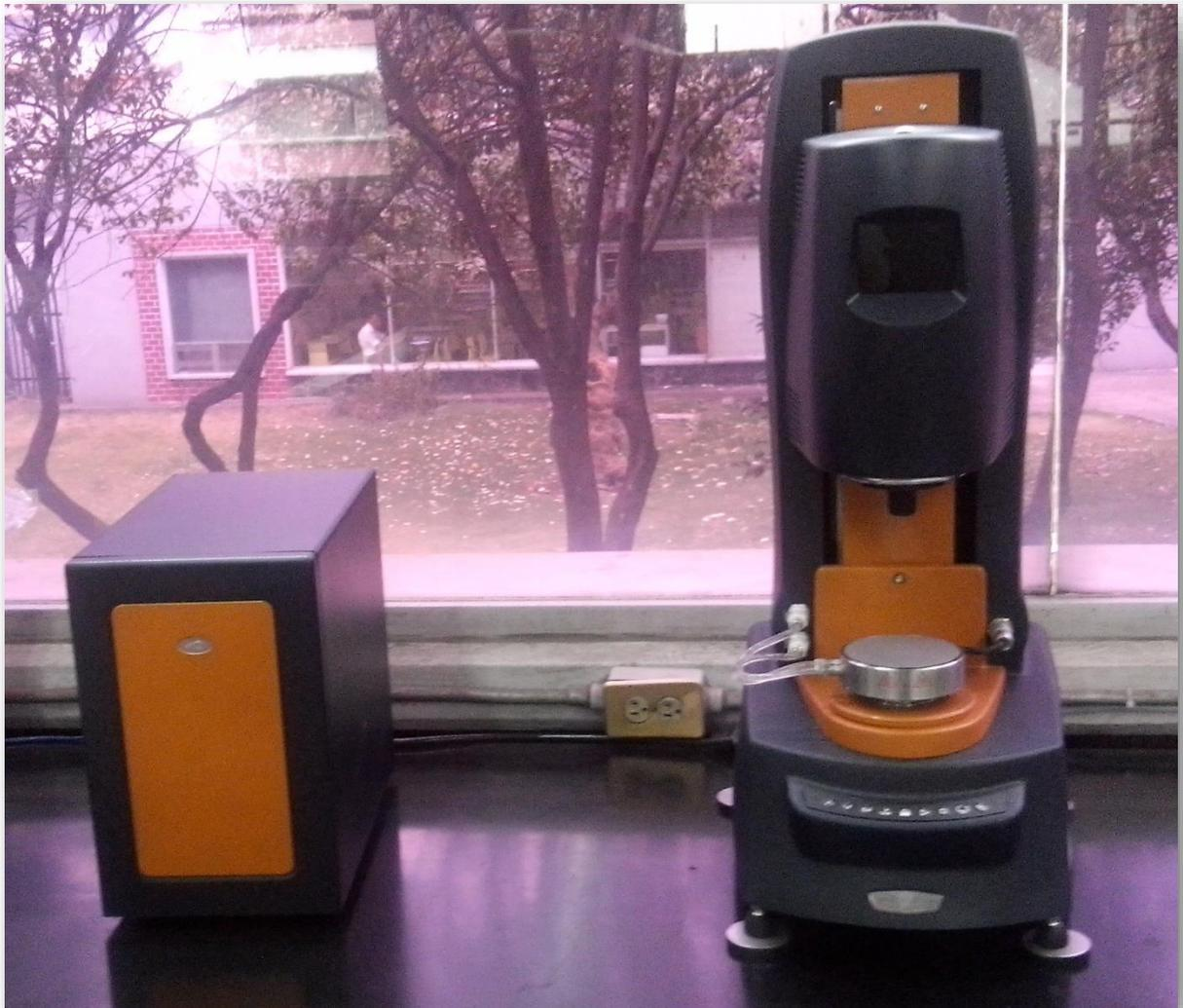
**Figura 10:Reómetro marca TA Instruments modelo DHR3.**
