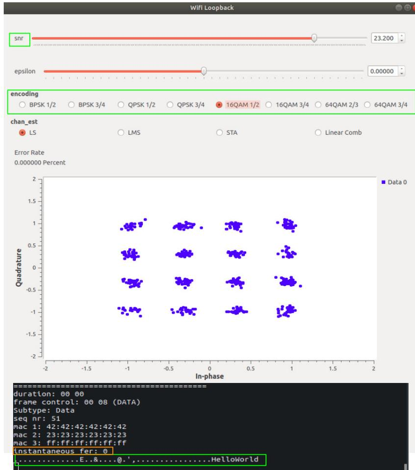
Figura 4.10: Modulación 16QAM con que se reciben los mensajes que se envían de la interfaz TAP y su correcta decodificación.
