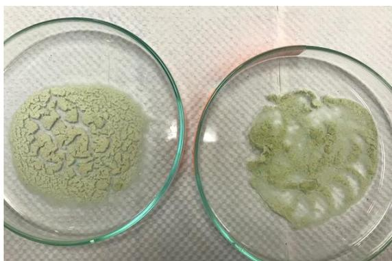
*Ilustración 18. Producto de reacción AE: SGST 70:30 y 2% Reactivo de Fenton con  $Cu^{2+}$*
