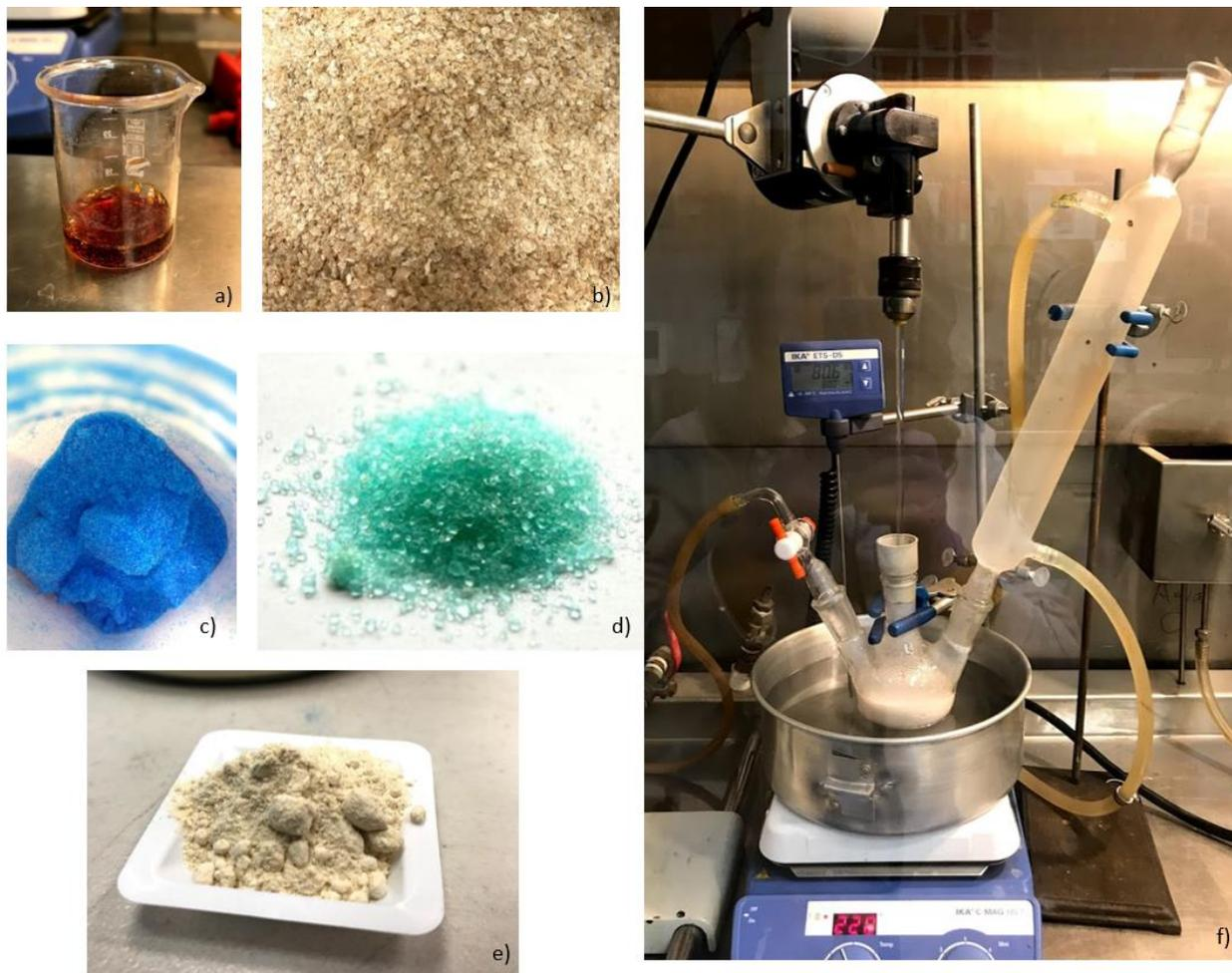
*Ilustración 16. a) Reactivo de Fenton, b) Xiloglucano purificado, c) Sulfato cobre (II), d) Sulfato de hierro (II), e) Sólidos granulares de semilla de tamarindo y f) Sistema de reacción: matraz de bola con tres bocas en baño de aceite y parrilla de agitación, entrada de nitrógeno, entrada de rotor para agitación y entrada de refrigerante, con sistema digital para regulación de temperatura.*
