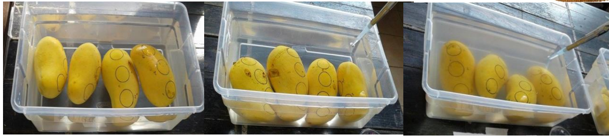
Figura 17: Tratamiento de hidrogenfriamiento con mango Ataúlfo control - (A), Tratamiento de hidrogenfriamiento con mango Ataúlfo y cloro (B), Tratamiento de hidrogenfriamiento con mango Ataúlfo y desinfectante con aceite de tomillo (C).
