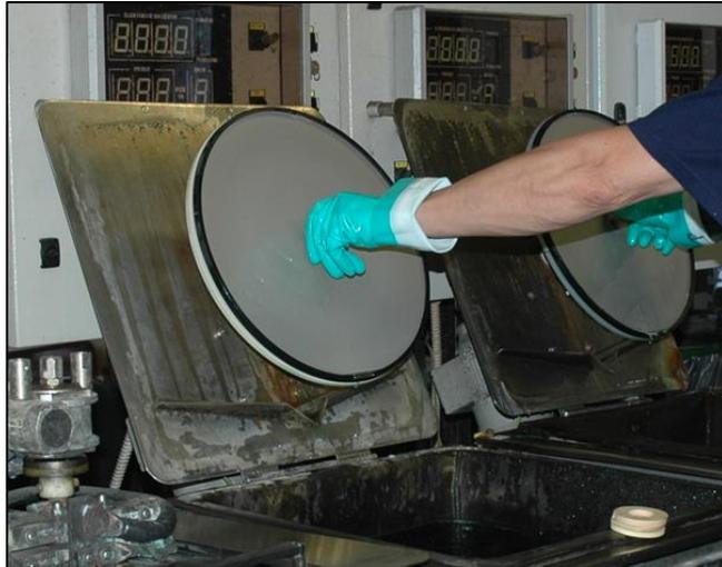
*Figura 82. Galvanizado del vidrio máster.*
