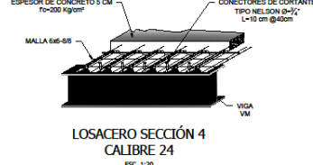
FIJACION DE LOSACERO EN VIGAS VM (LOSACERO SECCION 4 CALIBRE 22) ESC. 1:30
