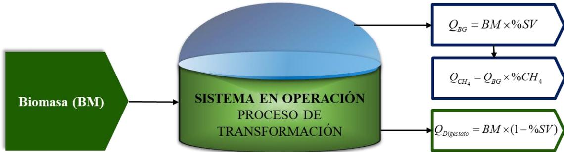
Figura 3. 9. Obtención de biogás, metano y digestato.
