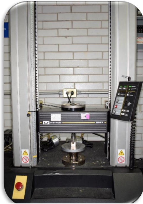
Figura 3. Máquina Universal de pruebas Instron (Modelo 5567, Norwood, USA: SGS US testing Company Inc.)
