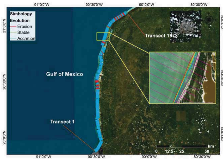
Figura 59. Procesos de evolución de la línea de costa. Línea roja indica erosión, línea verde sección estable y azul acreción.
