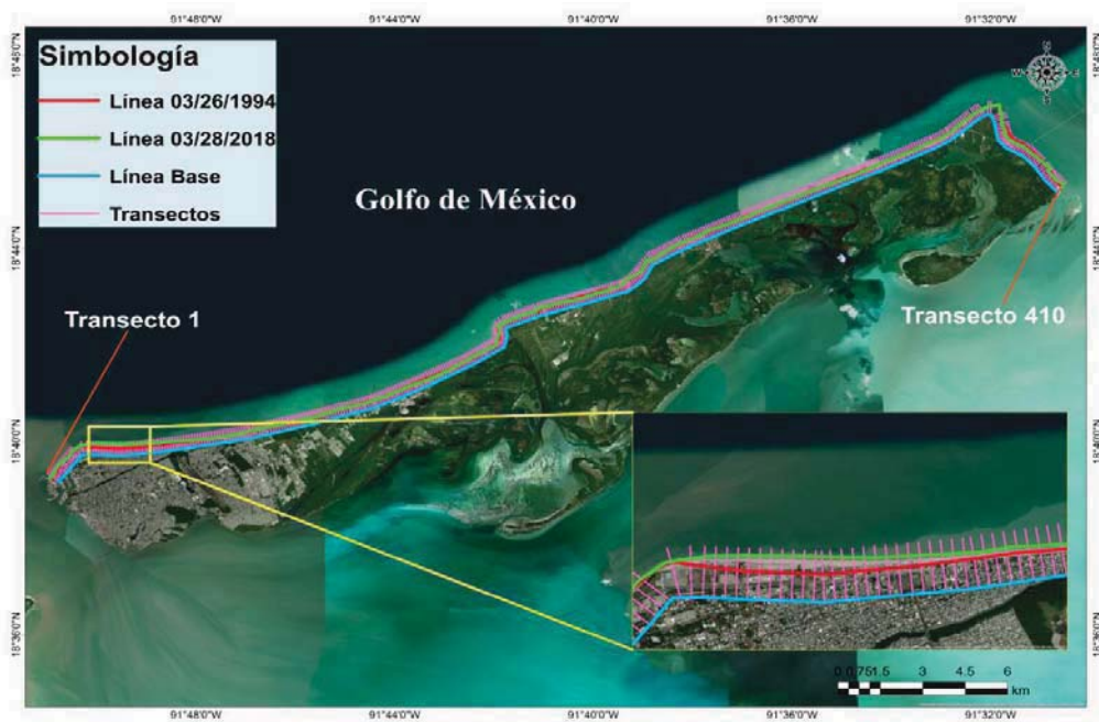
Figura 71. Sección b. Periodo de análisis 1994 - 2018. En el recuadro zona con mayor acreción (Playa Norte).
