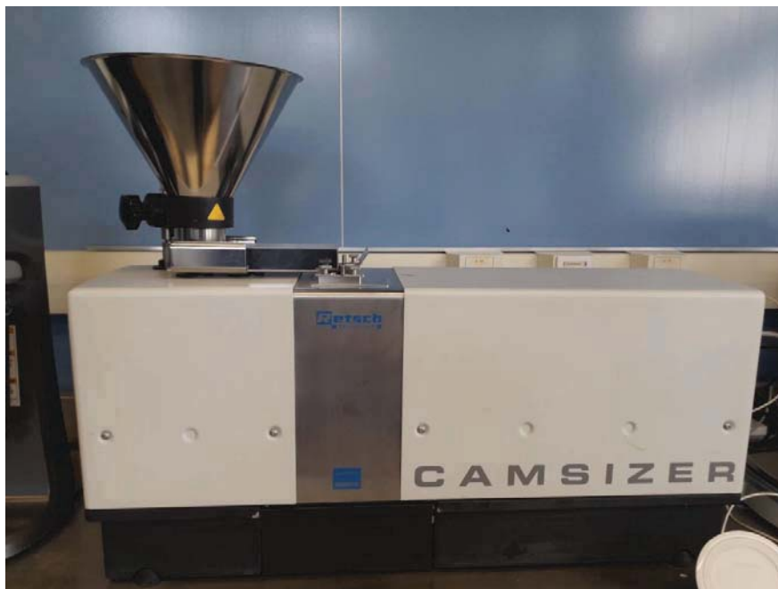
Figura 3. Equipo CAMSIZER, empleado para medir la distribución granulométrica.
