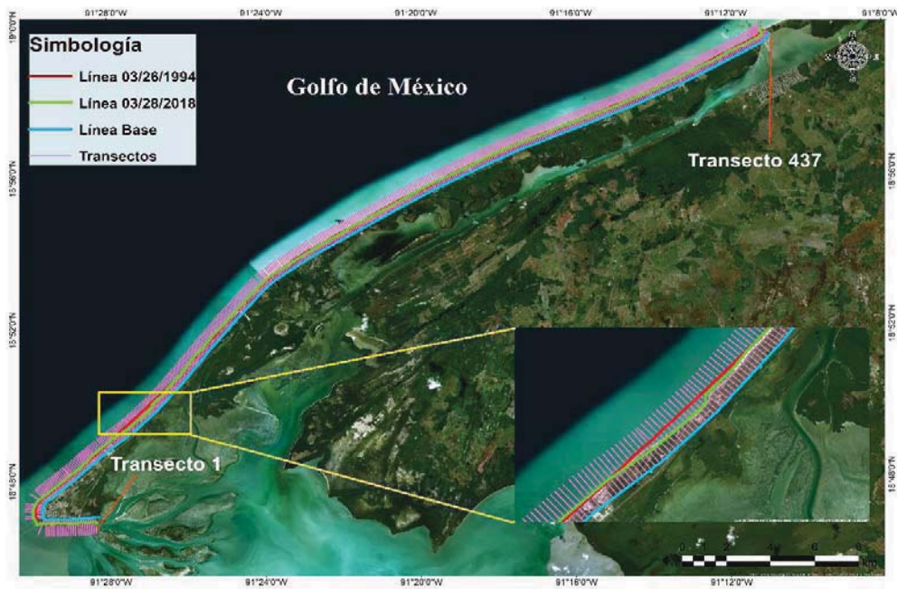
Figura 68. Sección a. Periodo de análisis 1994 - 2018. En el recuadro zona con mayor erosión (km 45).
