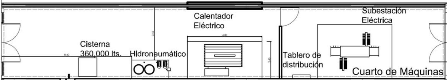
Imagen 138. Detalle cuarto de maquinas
