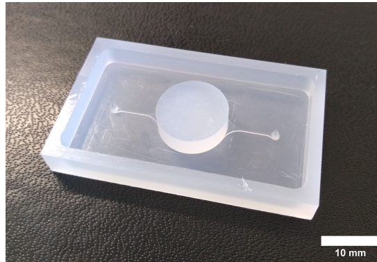
Figura 18: Molde de acrílico utilizado para realizar las réplicas de PDMS.
