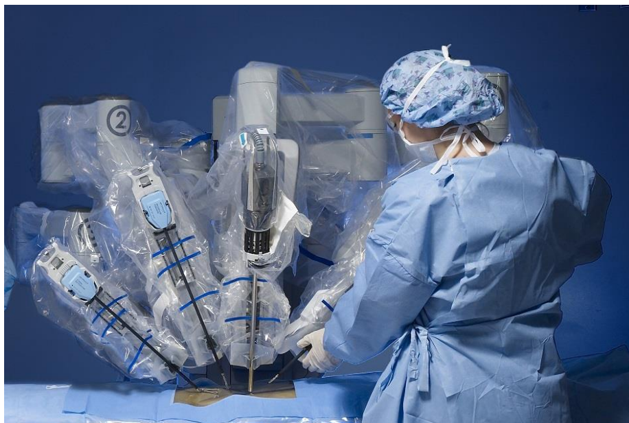
Ilustración 6 Ensamble en fundas estériles de carro del paciente del sistema Da Vinci.
