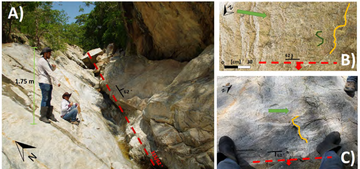
Figura 5.19: Evidencia en estación La Intersección: A) Cauce del río (la línea roja punteada indica la dirección donde se encuentra el plano de falla 315/62) B) y C) Indicadores cinemáticos (las líneas rojas punteadas indican la dirección hacia donde se encuentra el plano de falla, las líneas amarillas señalan los indicadores tipo fracturas riedel o conocidos también como cuñas y las flechas verdes indican el sentido de movimiento del bloque ausente). Octubre del 2019.
