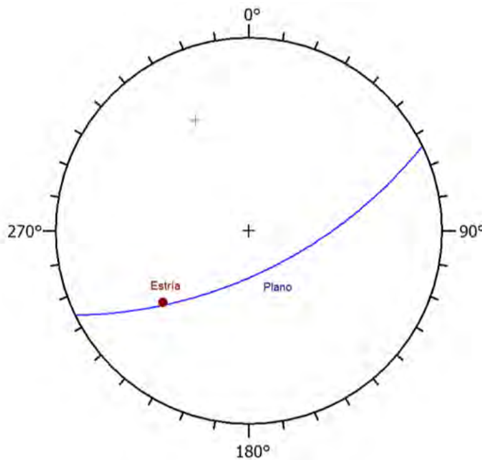
Figura 5.28: Actitud del plano de falla y estrías. Elaborado con Stereo32, 2019.
