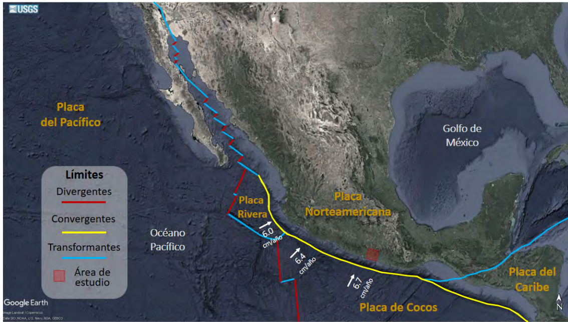
Figura 1.1: Límites tectónicos en México. Las flechas blancas indican la dirección y velocidad (cm/años) de convergencia (DeMets et al., 2010). Editado de United States Geological Survey (USGS) (2019). Elaborado con Google Earth Pro (2019).
