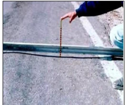
**Figura. 2.5. Deformación Longitudinal o Rodera** crédito: dirección general servicios técnico. SCT.
