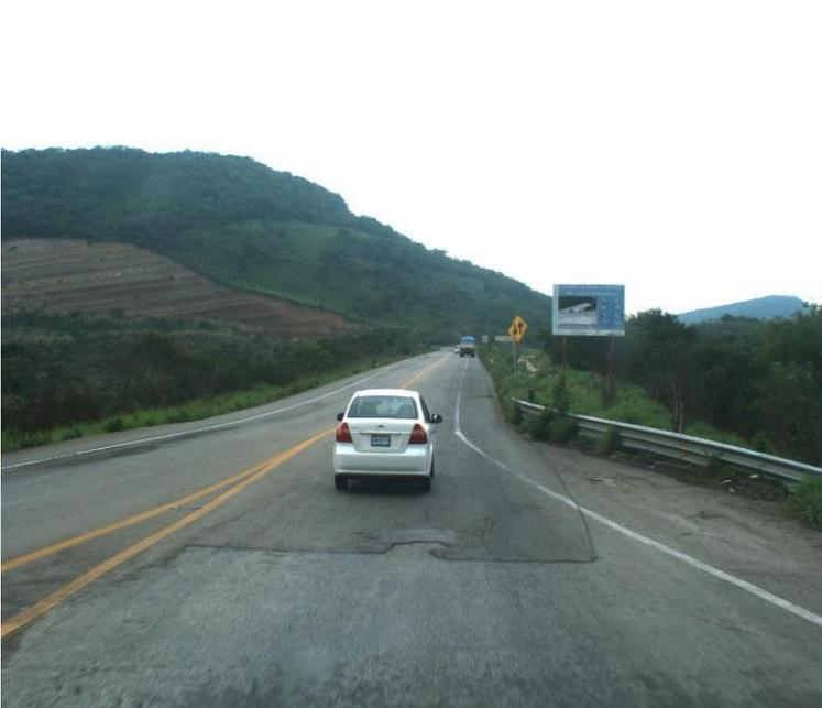
**Fig. 4.3** Se observa el escalón de la sobre carpeta Km. 5+250 creditos: Unidad Gal. Servicios
