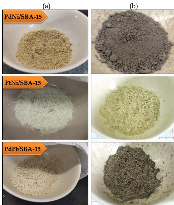
Figura 9. Catalizadores bimetálicos a) impregnados y b) calcinados
