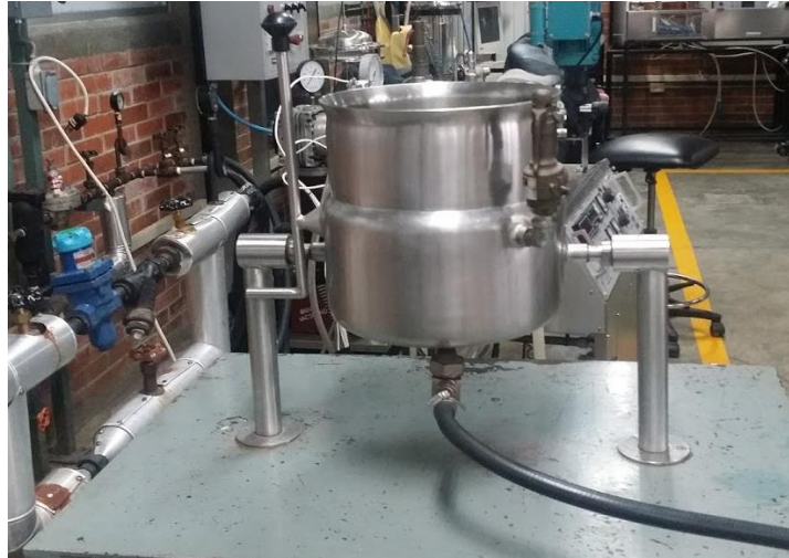
Figura 2. Marmita basculante de volteo (Aguilar,2017).
