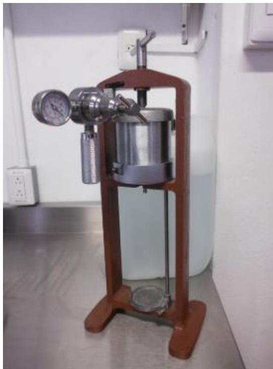
Figura 3.8 Filtro Prensa API
