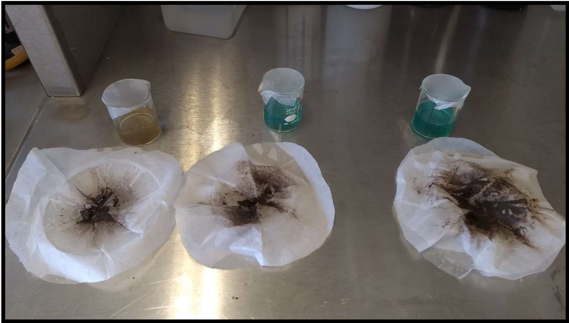
Figura 7. Lixiviados filtrados y residuos sólidos separados y secados.
