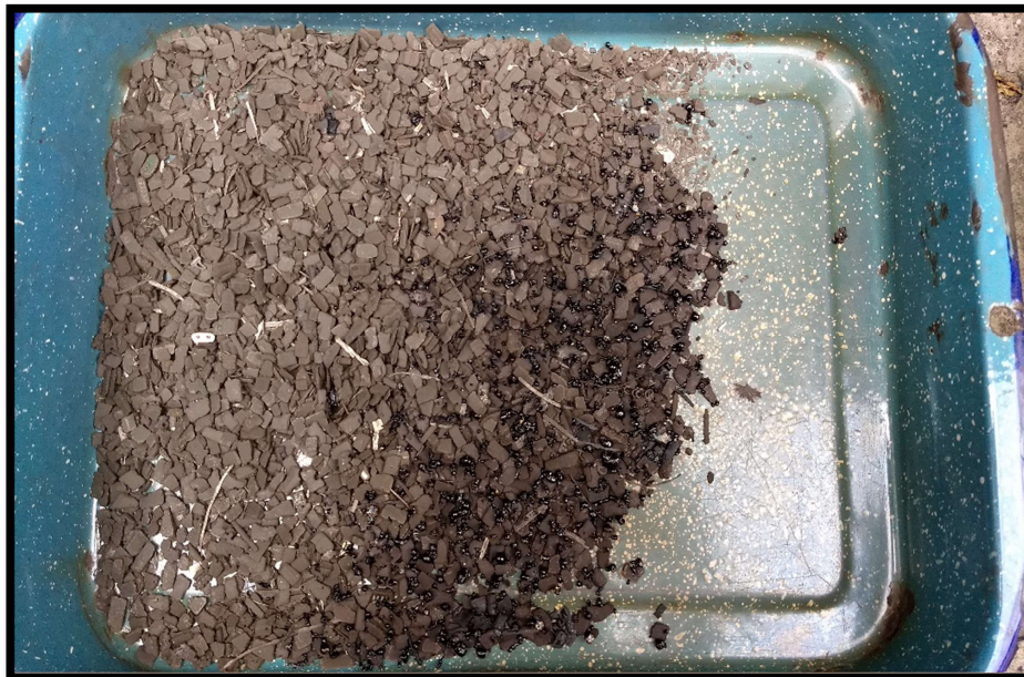
Figura 8. Material grueso después de que se introdujo en el horno. Se puede observar que en este se produjo más cantidad de ceniza, esto a causa que el material plástico restante era abundante.
