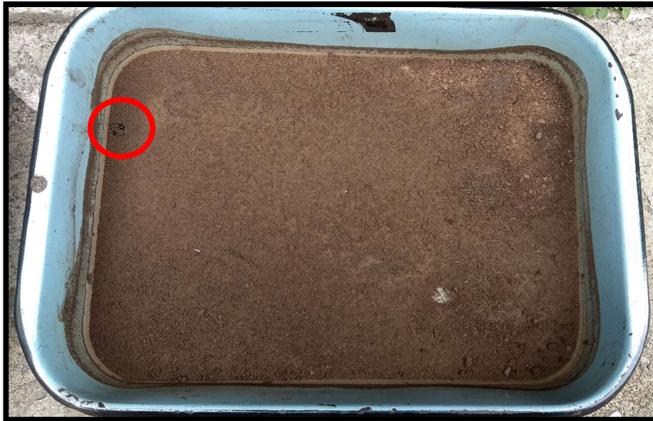
Figura 7. Material fino después de que se introdujo en el horno. Se puede observar solo una pequeña cantidad de ceniza (área marcada).
