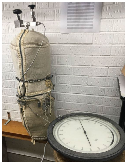
Figura 8. Sistema para pruebas a altas presiones y temperaturas.
