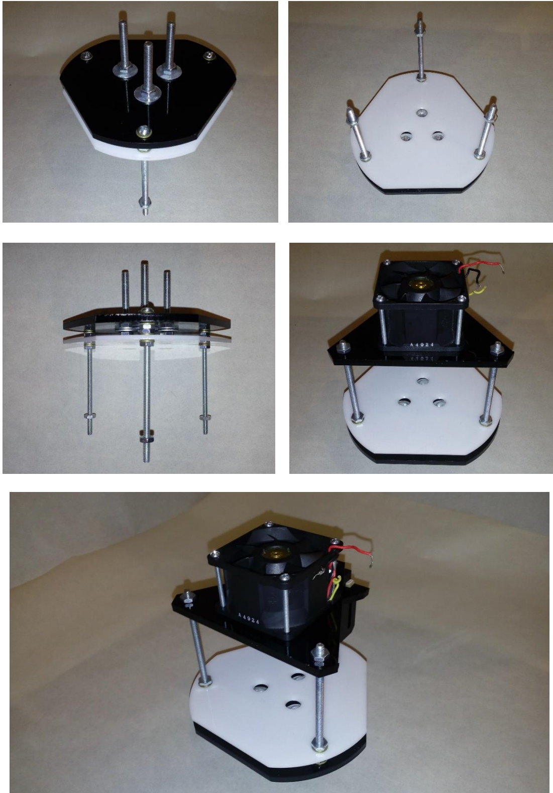
Fig. 85 Ensamble del soporte de acrílico
