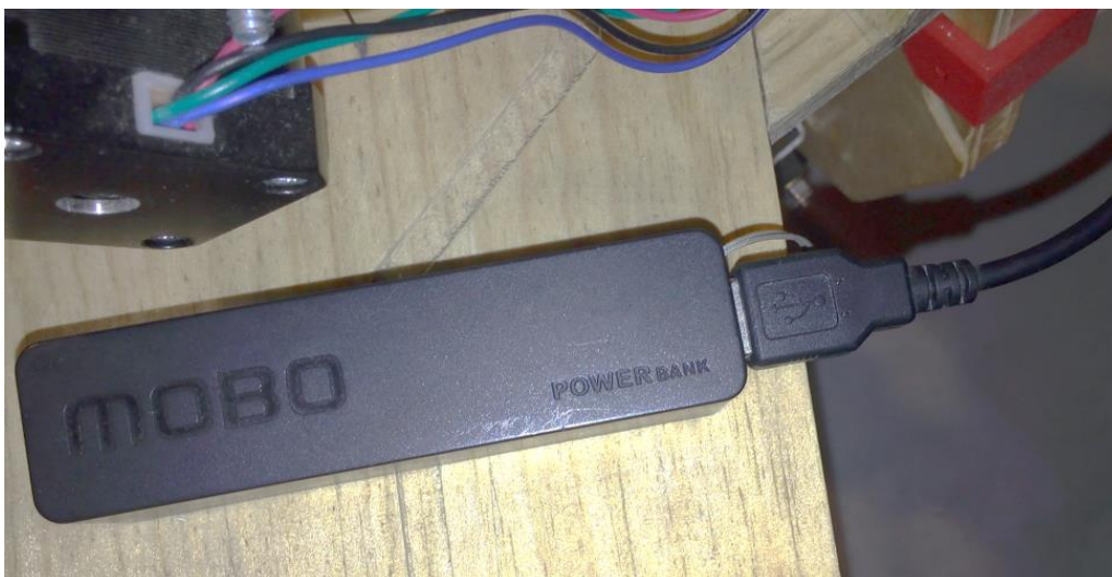
Fig. 124 Banco de baterías
