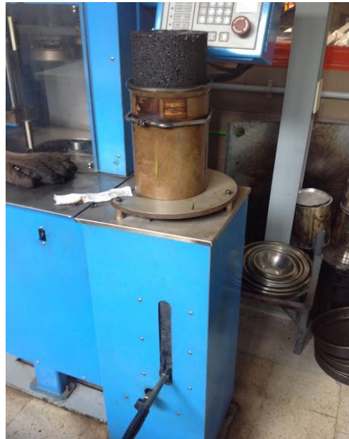
Figura 3.10.10 Extracción de probeta de mezcla asfáltica del molde de compactación. Elaboración propia.
