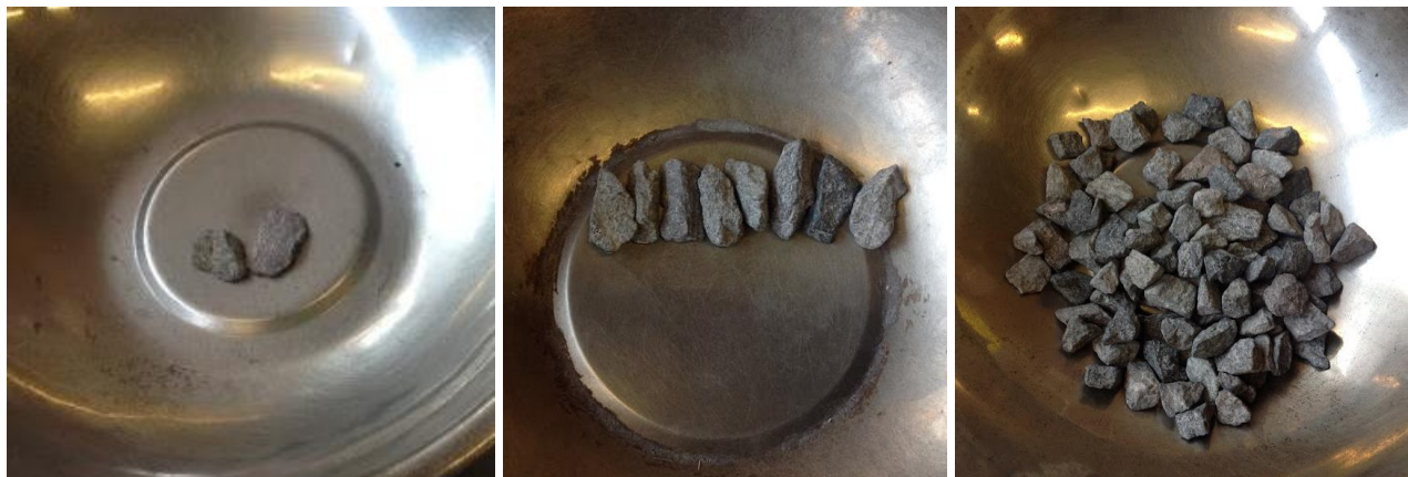
Figura 3.4.1. Partículas Planas (Izquierda), Alargadas (Centro) y que no son planas ni alargadas (Derecha). Elaboración propia.
