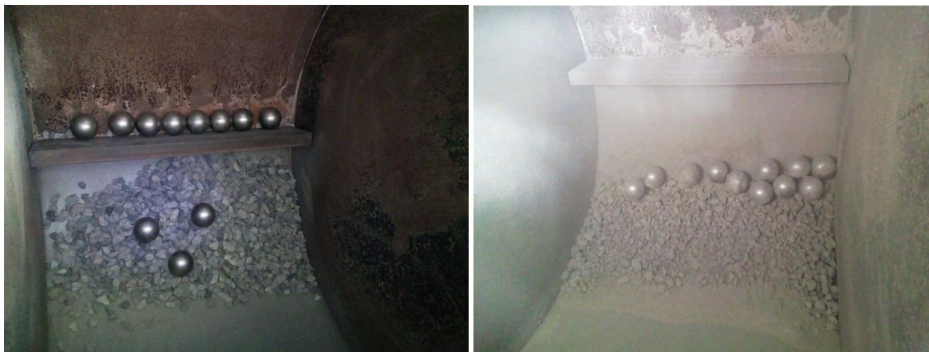
Figura 3.6.2 Agregado antes y después de la Prueba de Los Ángeles. Elaboración propia.
