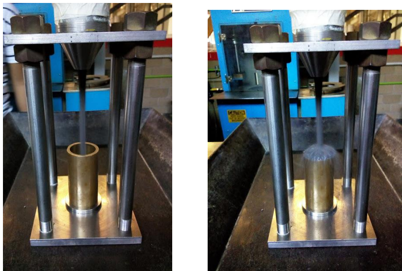
Figura 3.3.2 Llenado del cilindro para la prueba de angularidad del agregado fino. Elaboración propia.
