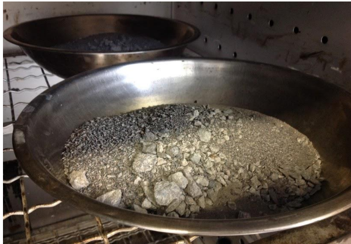
Figura 3.10.4 Agregado pétreo dentro del horno a 155° para mezclado Elaboración propia.
