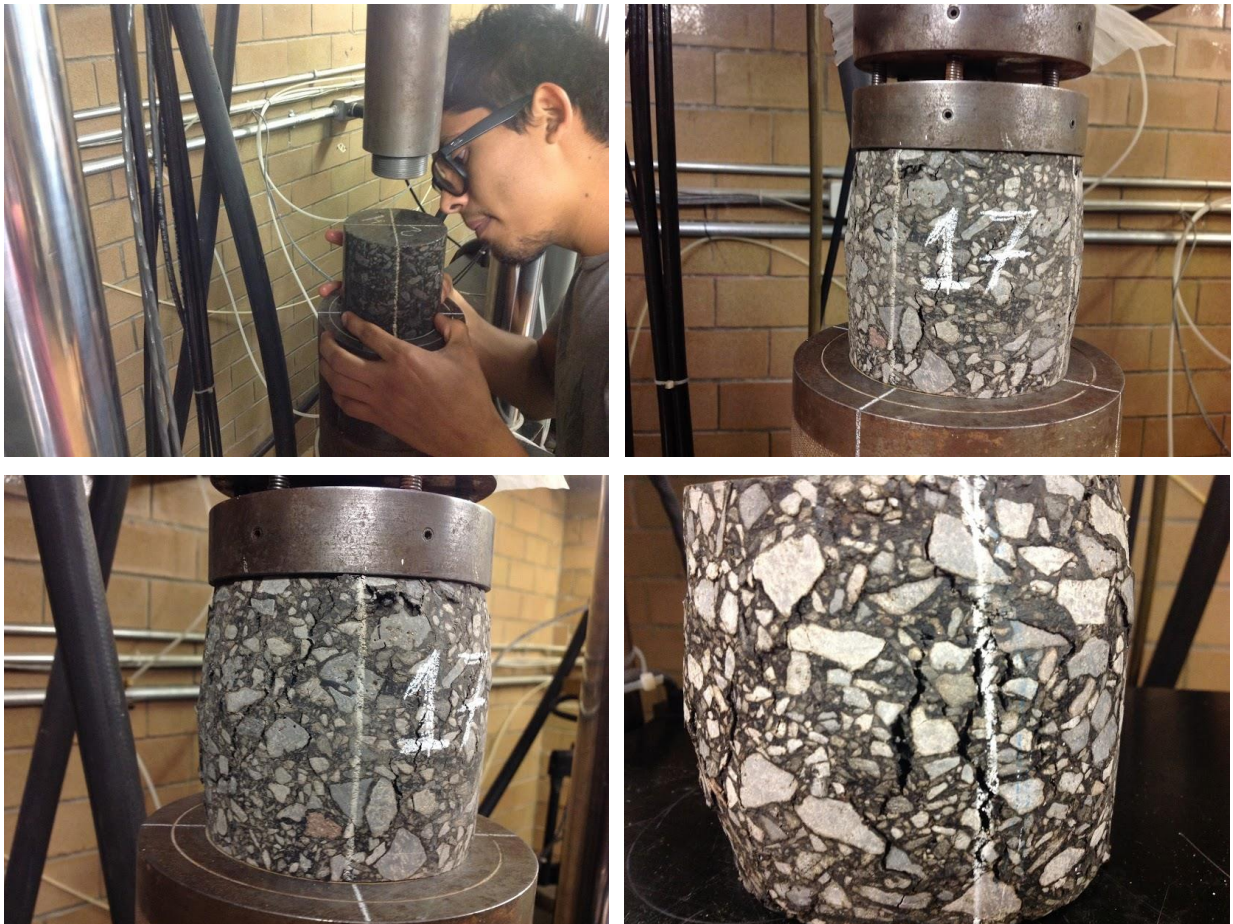
Figura 4.1.1 Colocación, ejecución y finalización de la prueba a compresión simple en probetas de mezcla asfáltica. Elaboración propia
