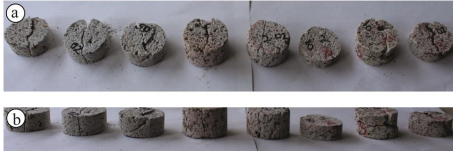
Figura 44. a) especímenes fallados. b) visualización de la forma de la falla longitudinalmente,
