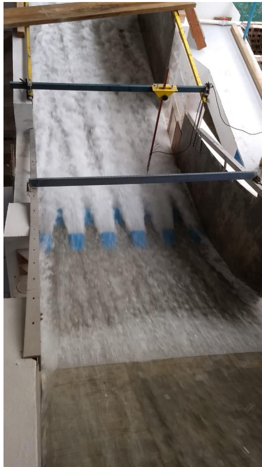
Figura 7.1 comportamiento salto para el escenario 1 con deflectores
