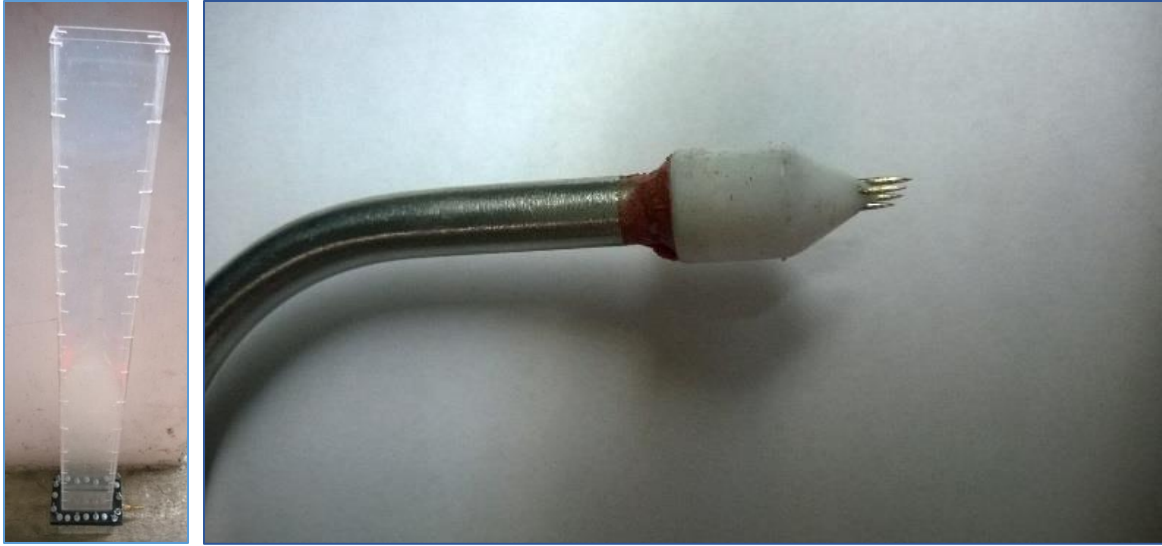
Figura 4.2 Configuración de la cámara de burbujas y sonda de cuatro sensores
