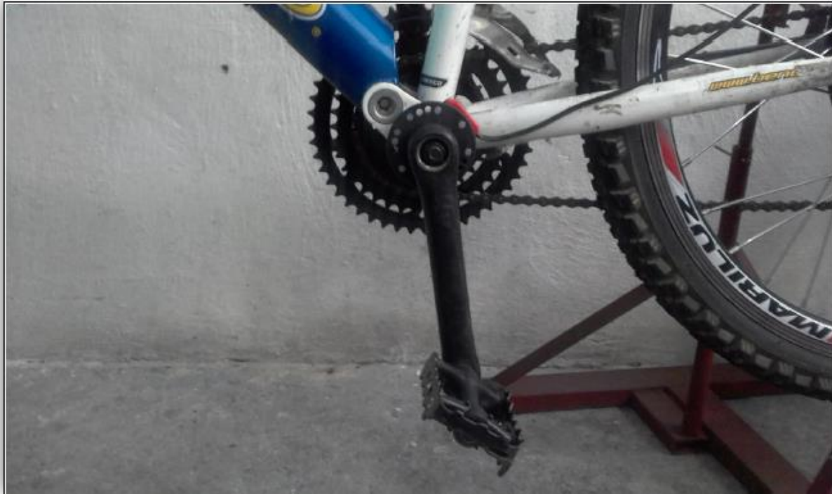
Figura 2.5 Anillo de imanes colocado en el pedal de la bicicleta
