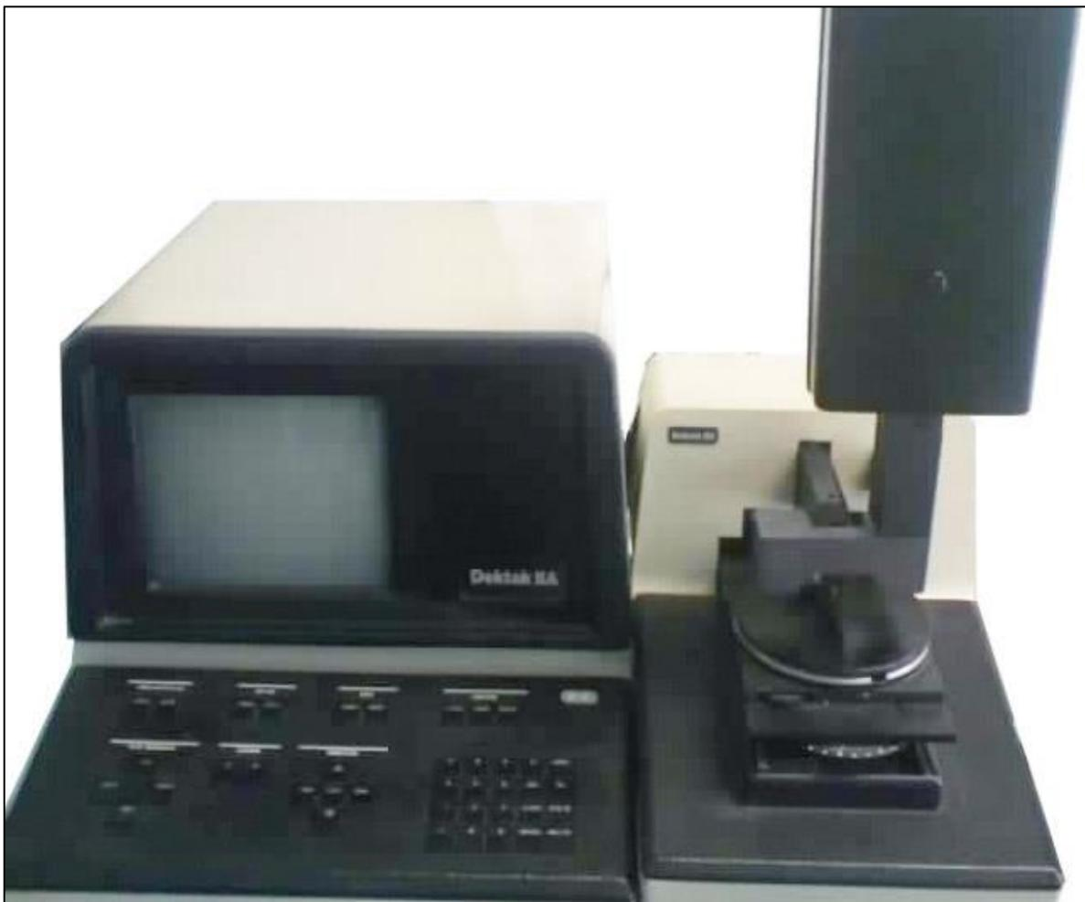
*Figura 15.* Fotografía del perfilómetro Sloan/Veeco Dektak IIA [46].
