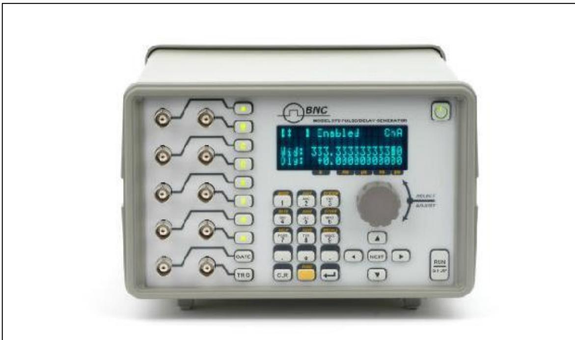
**Figura 10.** Fotografía del generador de pulsos 575-8C Berkeley Nucleonics [17].
