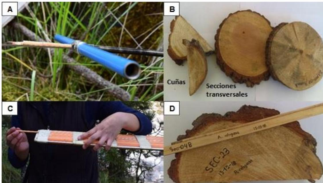
Figura 3.2. Herramientas para la colecta de muestras. (A) Los núcleos se extraen con barrenos de extracción tipo *Pressler*. (B) Las cuñas y las secciones transversales se toman con una motosierra. (C) Los núcleos de extracción se guardan en "popoteras" para ser transportados seguros al laboratorio. (D) A cada muestra se le asigna una clave para identificarla.
