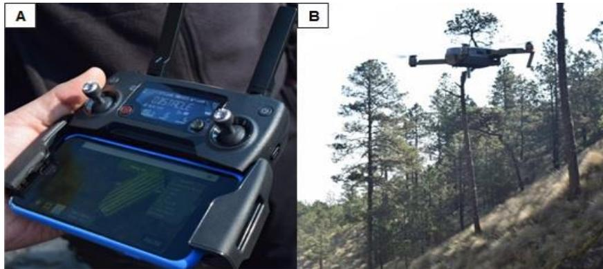
Figura 3.6. (A) Planificación del vuelo con la aplicación Pix4DCapture. (B) Dron en vuelo a ~3450 msnm para la toma de fotografías aéreas escala 1:3,980.
