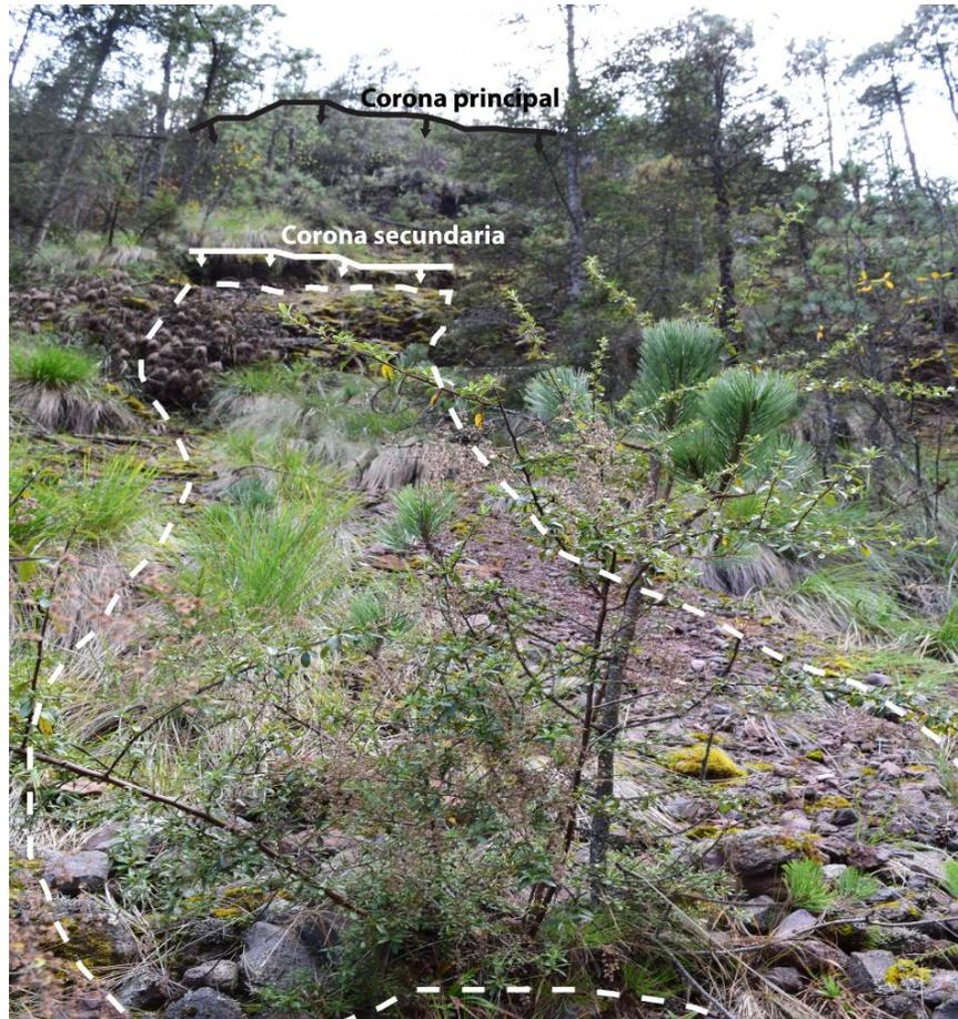
Figura 4.17. Se observa la corona principal del deslizamiento y la corona de un deslizamiento posterior de menor dimensión que se desarrolló sobre el depósito del primer deslizamiento. La línea punteada delimita el depósito del deslizamiento más pequeño. En la parte inferior de la imagen es posible observar que los materiales del depósito sepultaron parcialmente algunos renuevos.
