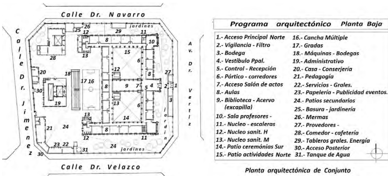
Imagen 121: Planta arquitectónica del conjunto urbano Asilo de Ancianos el Buen Retiro. Esc: aproximada.
