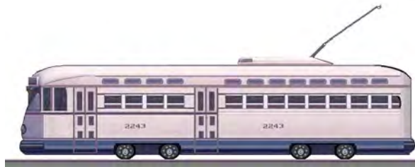
Imagen 95: Alzado tranvía eléctrico modelo PPC electric 2000. Una cabina 100 pasajeros, fabricado por St. Louis Car USA, ensamblado en Talleres de Indianilla por México Trainways Company 1952. Dibujo: F.V.A.
