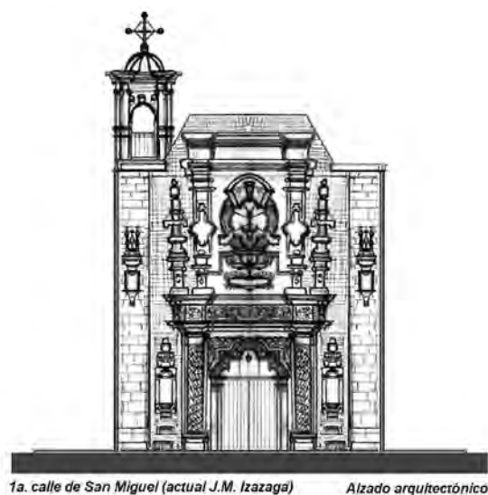
Imagen 67: Alzado oriente Capilla de la Inmaculada Concepción. Esc: aproximada. Isleta central del inicio de la Av. Izazaga (estado actual). Dibujo: F.V.A.
