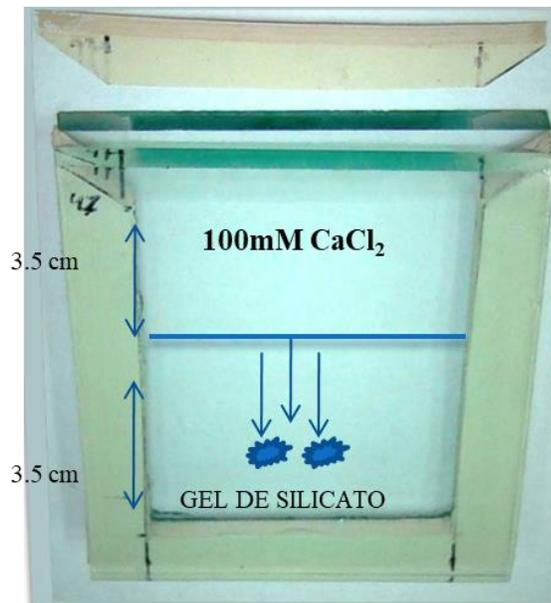
**Figura 2.** Sistema de contradifusión en gel de silicato.<sup>26</sup>
