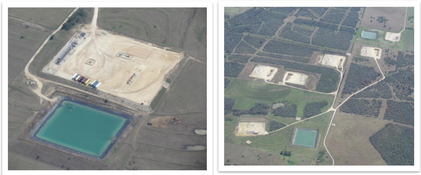
Ilustración 14. Depósitos de agua para uso en la técnica de la fracturación hidráulica
