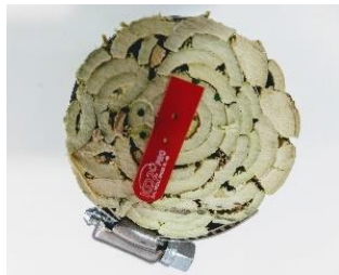
Imagen 17.- Probeta Arundo Donax
