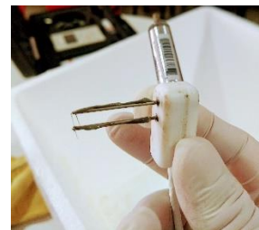
Imagen 19.- Sensor SH1 y grasa térmica
