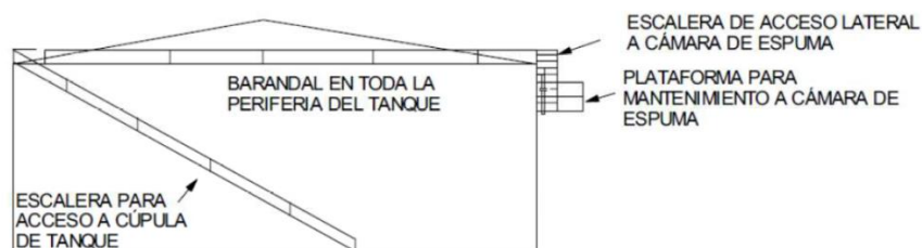
Figura 5.28 Ubicación de acceso a cámara de espuma. Tomada de NRF-015-PEMEX-2012.
