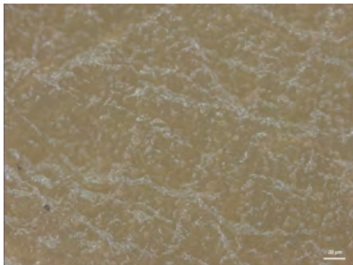
Figura 4.12: Muestra de pericardio bovino sin teñir utilizando un microscopio de campo oscuro por reflexión y un objetivo de 20X con una iluminación muy tenue.
