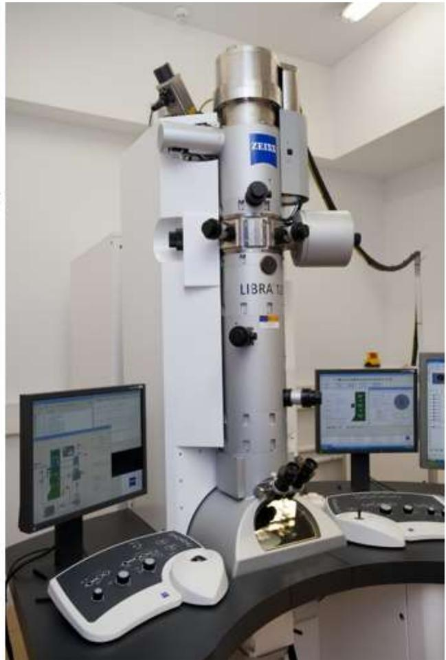
Figura 22.- Microscopio electrónico de transmisión (Dubessy et al., 1989).
