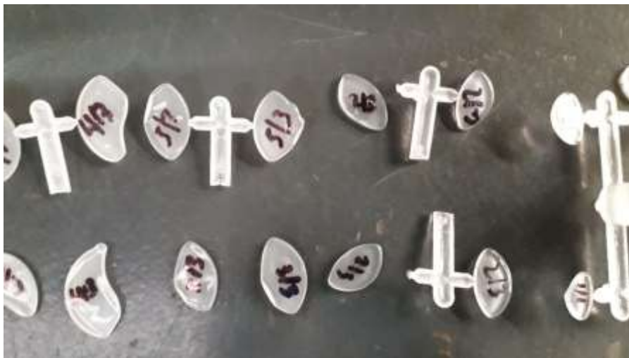
Imagen 56 Paletas obtenidas durante la ventana cosmético de proceso
