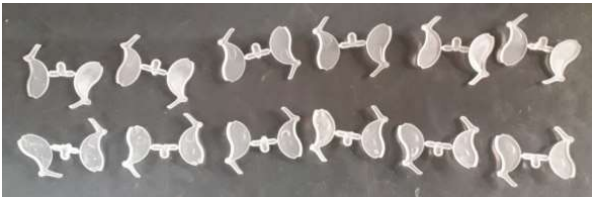
Imagen 44. Piezas obtenidas sello de compuertas molde 3
