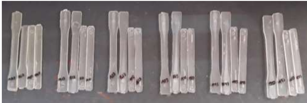
Imagen 24. Piezas obtenidas en sello de compuertas molde 1
