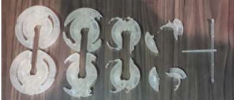
Imagen 48. Piezas obtenidas en caída de presión molde 4.
