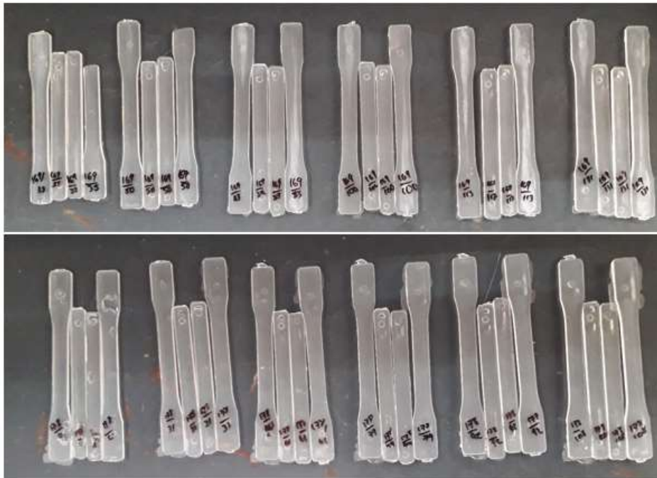
Imagen 23. Piezas obtenidas en ventana cosmética de proceso
