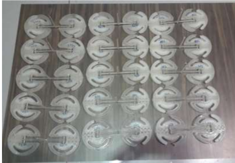
Imagen 46. Piezas obtenidas durante la curva de viscosidad molde 4.
