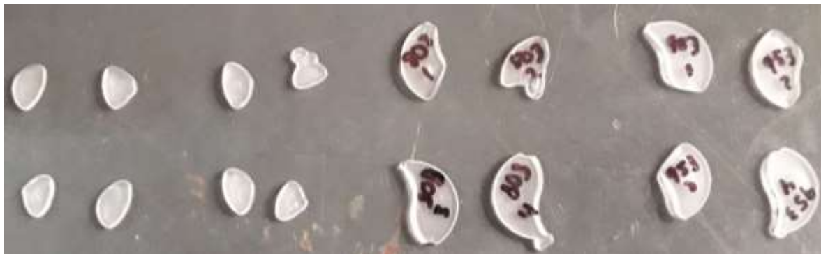
Imagen 42. Piezas obtenidas en balanceo de cavidades molde 3
