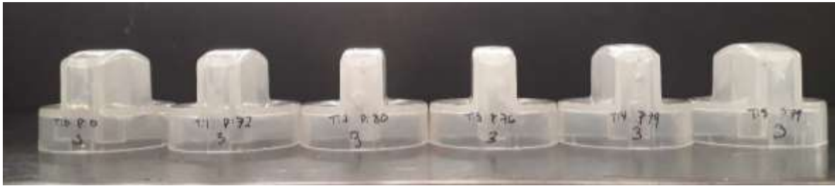
Imagen 39. Piezas obtenidas del cierre de compuertas cavidad A
