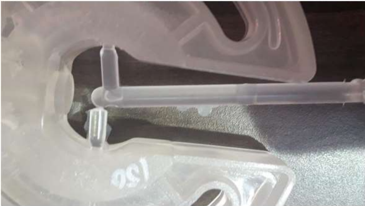
Imagen 58 Rebabas presentes en nodos, aún sin llenar la pieza
