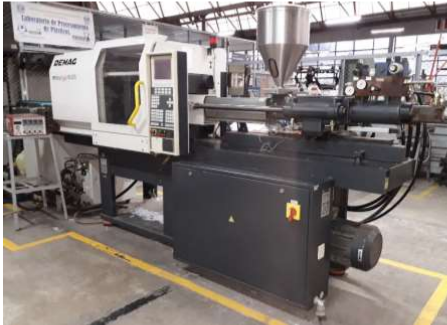
Imagen 6. Máquina de inyección marca DEMAG Ergotech 50/270 7 con capacidad de fuerza de cierre de 50 ton.
