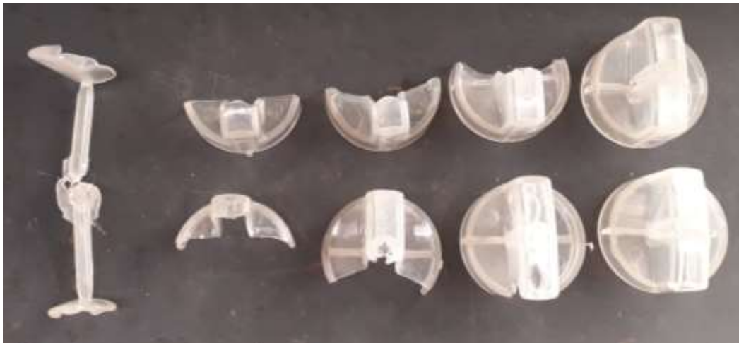
Imagen 33. Piezas obtenidas en caída de presión molde 2.
