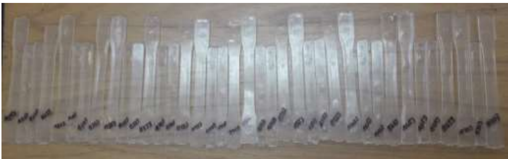
Imagen 25. Piezas obtenidas tiempo de enfriamiento molde 1
