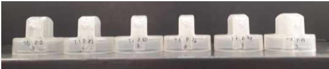
Imagen 40. Piezas obtenidas del cierre de compuertas cavidad B
