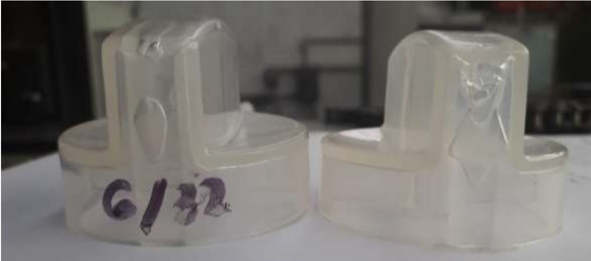
Imagen 36. Pieza obtenida con 6 [s] de tiempo de mantenimiento, 58 [cm 3 ] de volumen y 90 [bar] de presión de mantenimiento
