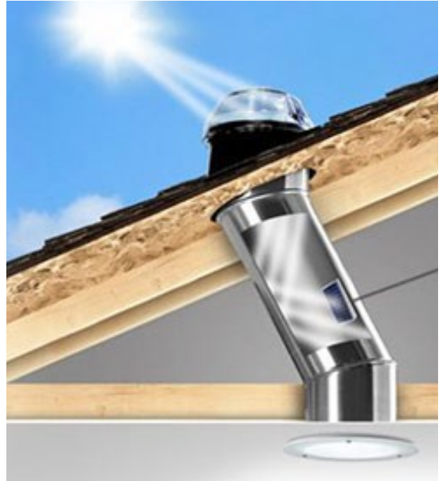
Diagrama de funcionamiento de el sistema solatube 35
