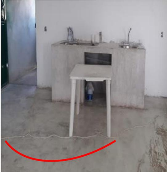
En la quesería de una UPP utilizan una extensión para conectar una bomba de agua. La extensión atraviesa de un lado a otro toda el área de producción. Esta falla pone en riesgo al personal encargado de la elaboración de quesos, pues cualquier tropiezo con el cable puede provocar incidentes o accidentes dentro de esta área.
