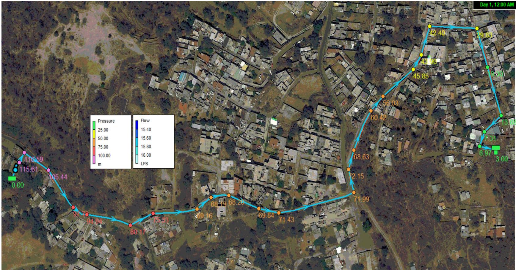
Figura 43. Modelación Hidráulica utilizando Software EPANET 2.0 simulando la línea de conducción de 6 pulgadas (152 mm) de diámetro de la Colonia Tecacalanco.
