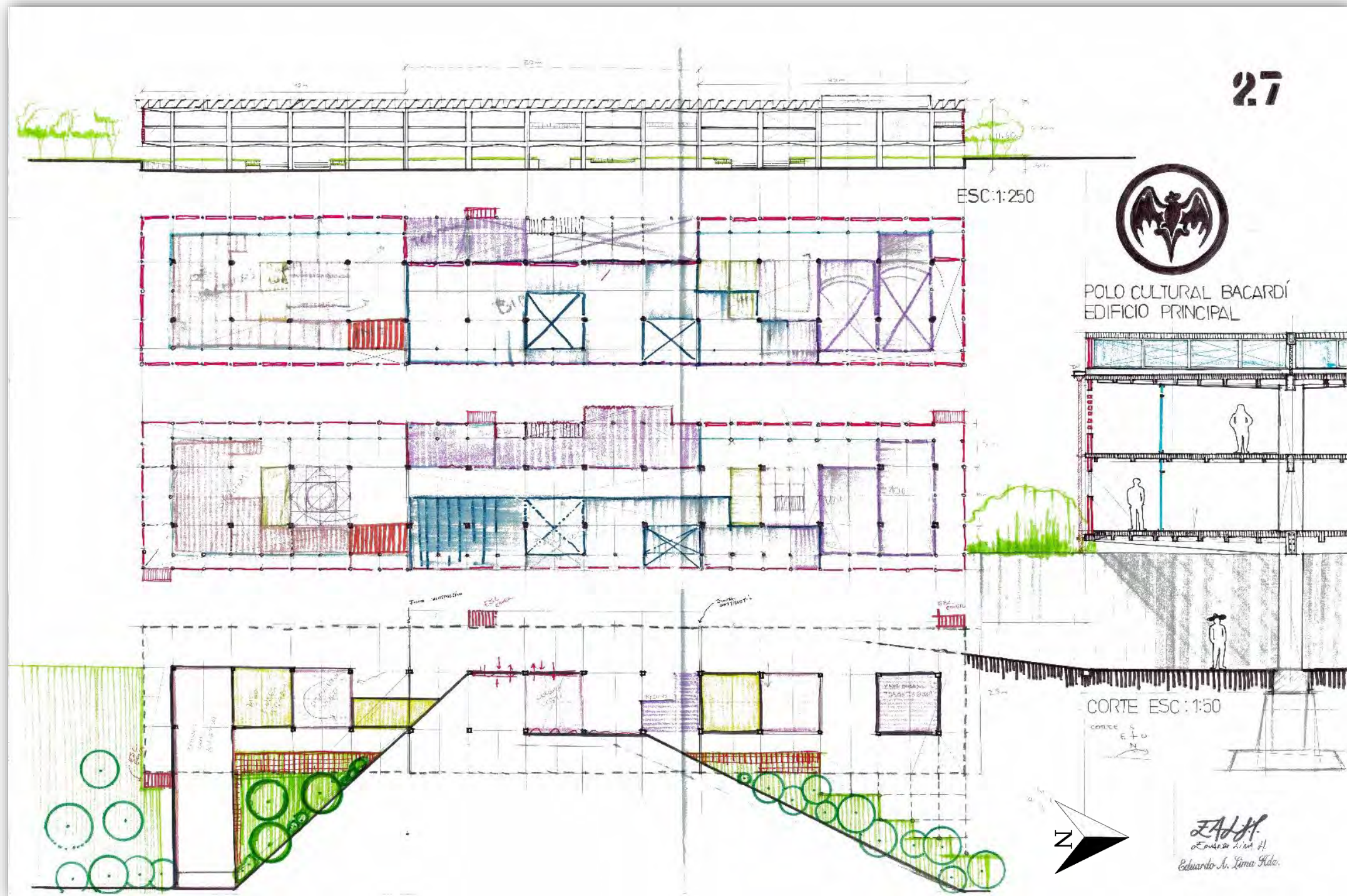
Fig. 316 Distribución de áreas del edif. Principal con estructura en corte, planta baja (de acceso), primer nivel y segundo nivel. séptima exploración. Noviembre 2018
