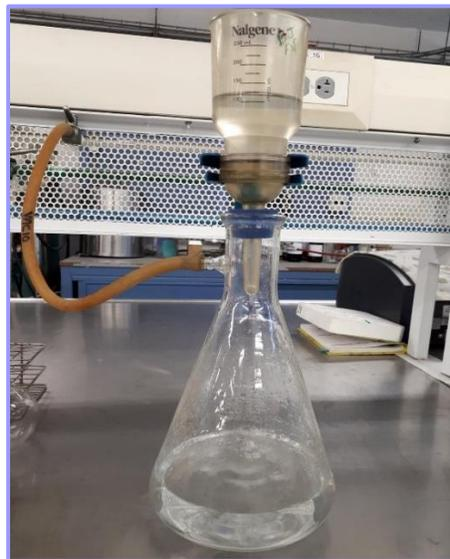
FIGURA 21. FILTRACIÓN DE LA SOLUCIÓN ISOTÓNICA 0.9% m/v.
