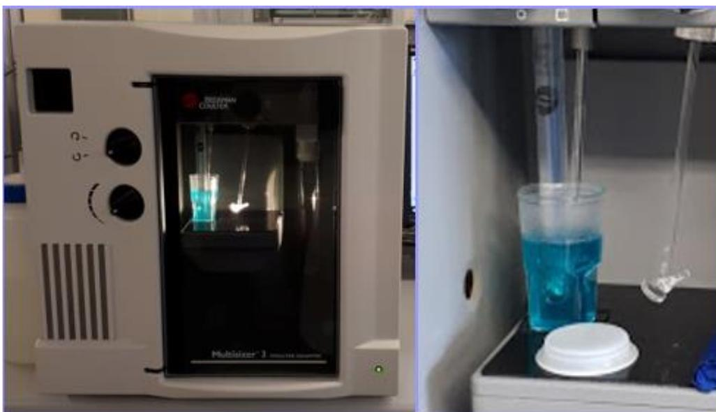
FIGURA 26. CELDA PUESTA EN SOLUCIÓN LIMPIADORA.
