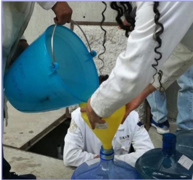
FIGURA 12. MUESTREO DE AGUA DE LLUVIA EN EL PUNTO S, UBICADO EN EL SISTEMA DE ALMACENAMIENTO DE LA AMC.
