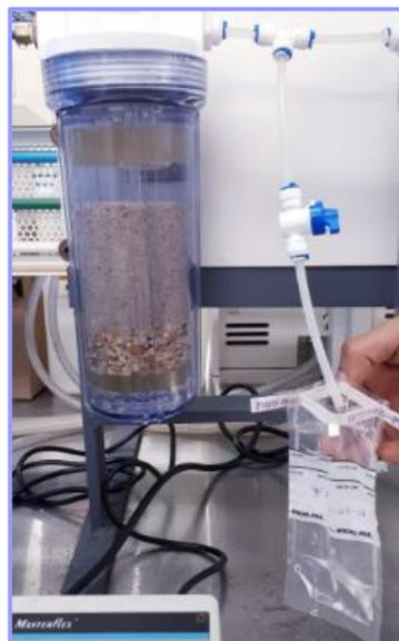
FIGURA 203. TOMA DE MUESTRAS DE LOS EFLUENTES PARA LA DETERMINACIÓN DE COLIFORMES FECALES Y TOTALES.
