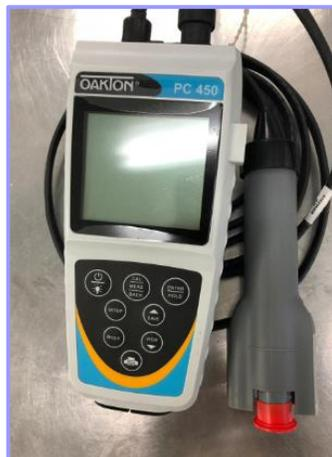
FIGURA 33. DETERMINACIÓN DE SDT USANDO UN MULTIPARÁMETRO.
