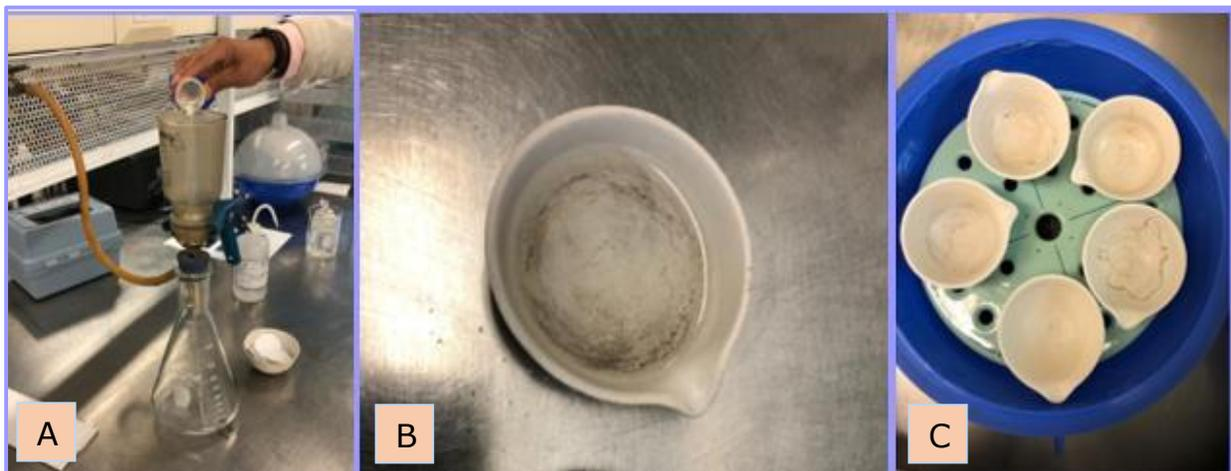
FIGURA 34. DETERMINACIÓN DE SDT USANDO NMX-AA-034-SCFI-2015.
