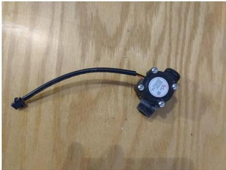
Figura 24: sensor de flujo yf s201
