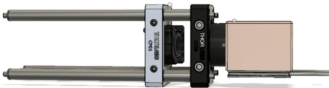
Figura 6.2: Filtro dieléctrico seleccionador de longitud de onda.
