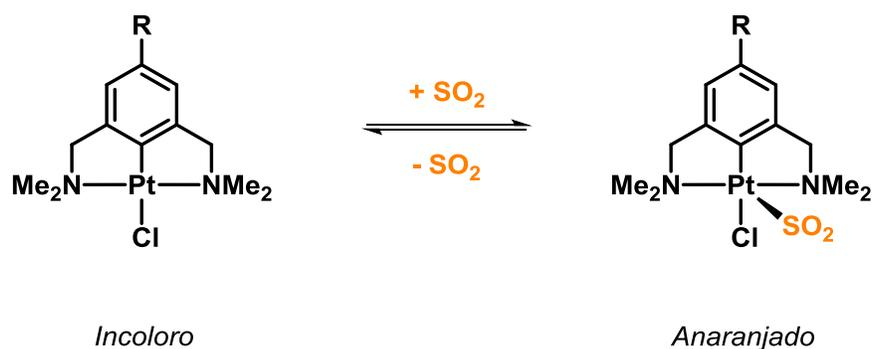
*Esquema 12. Reacción reversible de SO<sub>2</sub> con compuestos pinza NCN de Pt(II).*
