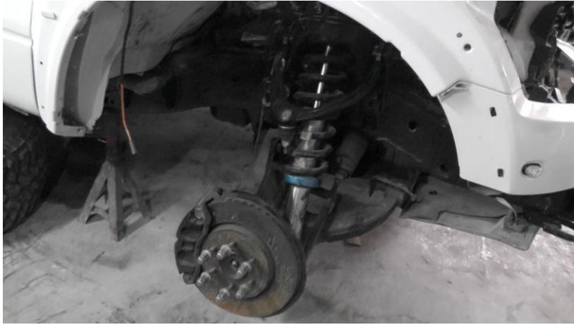
**Figura 8.** Suspensión de trapecios superpuesto [Imagen en línea]. Disponible en: <http://www.todoautos.com.pe/portal/component/tag/taller-mecanico> [consultado: 02 -11 -2019].
