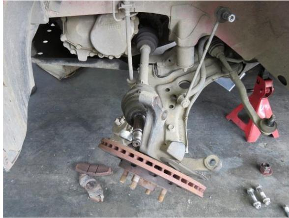
**Figura 7.** Configuración de una suspensión Mc Pherson.
