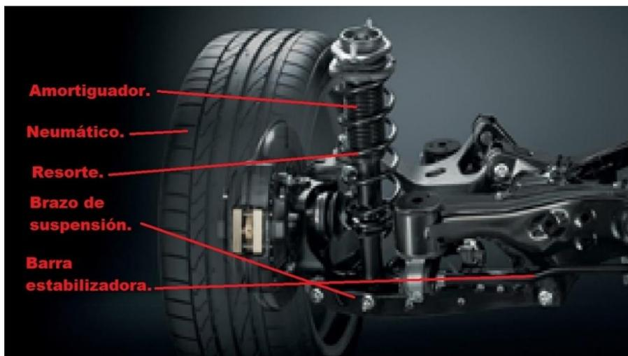
**Figura 5.** Elemento de suspensión de un automóvil.
