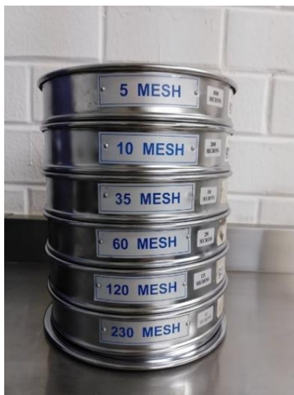
Figura 4.10. Juego de tamices utilizados para esta investigación. Los tamaños de malla van de los 4 mm a las 63 \mu\text{m} .
