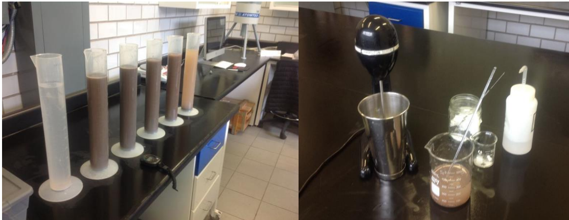
Figura 4.9. Imágenes donde se muestra los pasos llevados a cabo para determinar la textura mediante el método del hidrómetro. Las muestras fueron procesadas en el laboratorio Geocron-Q del LANGEM, UNAM.
