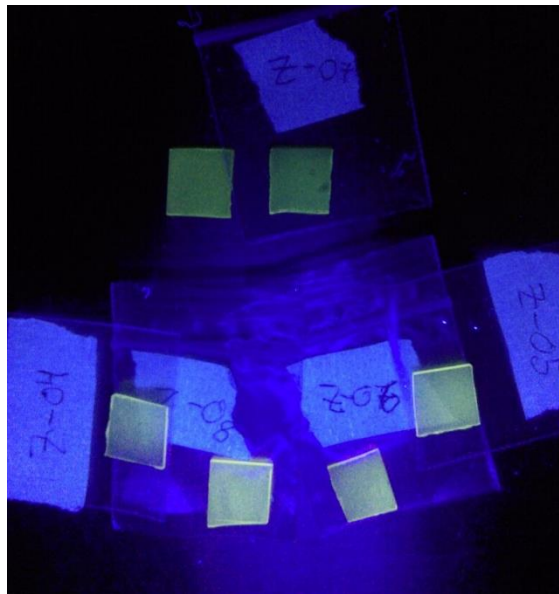
Figura 8 Prueba cualitativa de luminiscencia de las películas de ZnO.
