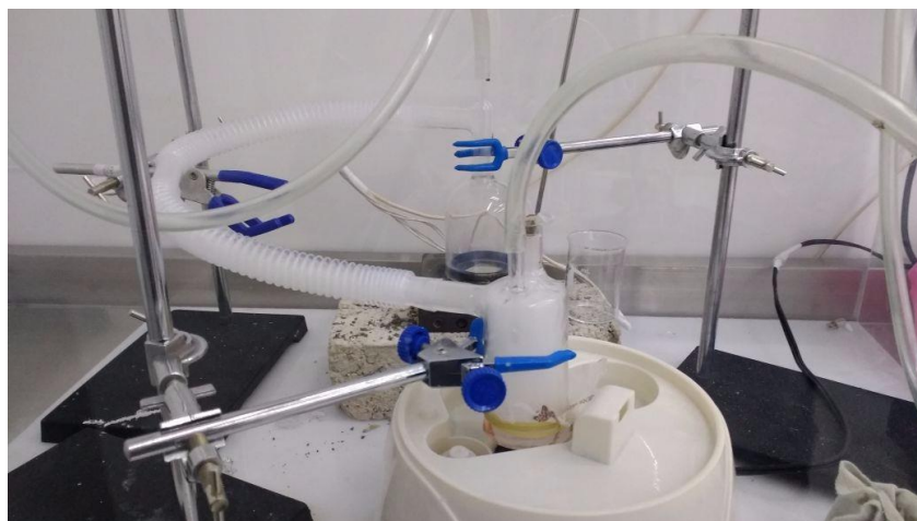
Figura 6 Sistema de crecimiento de rocío pirólítico por pulverización ultrasónica
