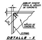
**ESTRUCTURACION DE COLUMNAS Y MURDOS DE RIGIDEZ**
