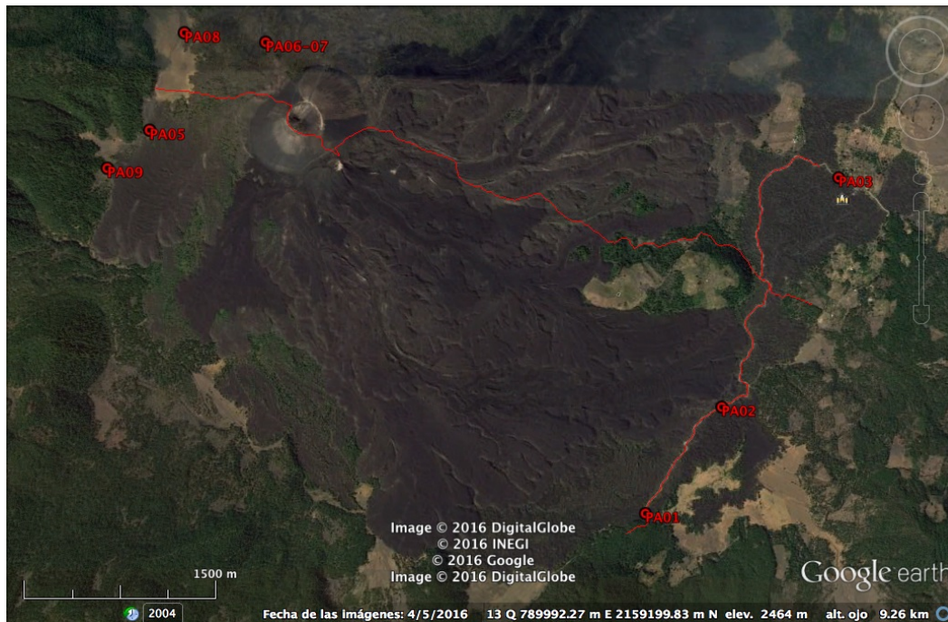
Figura 4.4. Imagen del Google Earth donde se muestran las rutas de los levantamientos magnetométricos y los puntos de medición geomagnética y paleomagnéticos PA01 al 09 (el norte esta a la derecha de la imagen).
