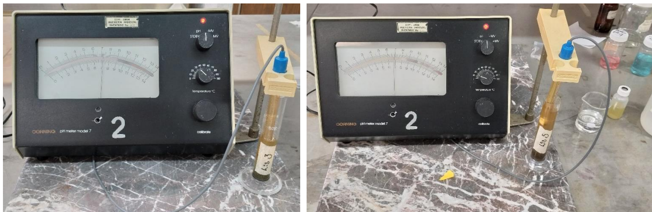
Figura 3.25 Toma de lecturas de pH para los lisímetros 3 y 5. Imagen propia.
