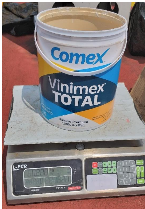
Figura 3.9 Pesaje de bote completo de pintura.
