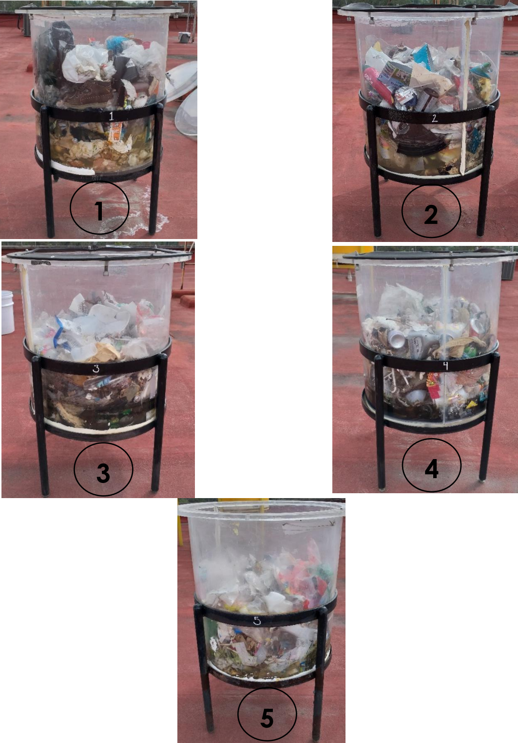
Figura 3.11 Lisímetros con inicio de generación de lixivados, 16-oct-2018.
