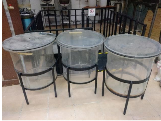
Figura 3.3 Lisímetros que se utilizaron para simular basureros a cielo abierto.
