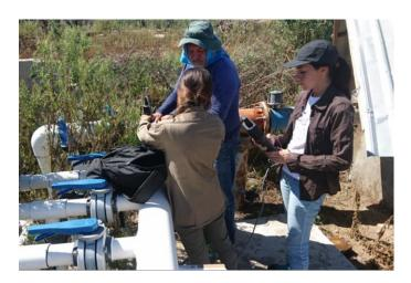
Figura 8.5 Toma de parámetros fisicoquímicos por medio de sonda multiparamétrica.
