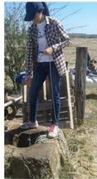
Figura 8.2 Toma de muestras de aguas subterráneas por medio de bomba y muestreador Bailer
