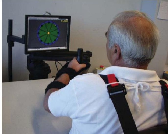
Figura 5. Equipo comercial InMotion2 [17], sirve para dar ejercicios en el brazo.
