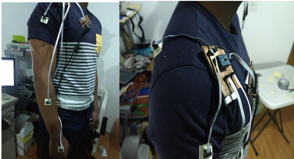
Figura 56. Sistema electrónico instalado en sujeto de prueba.
